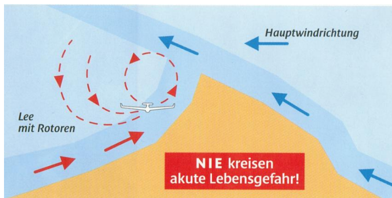
Abb. 5 Auf der Leeseite bildet sich ein Rotor, welcher für ein Segelflugzeug sehr gefährlich ist, weil die Auf- und Abwinde sehr stark sind.*
